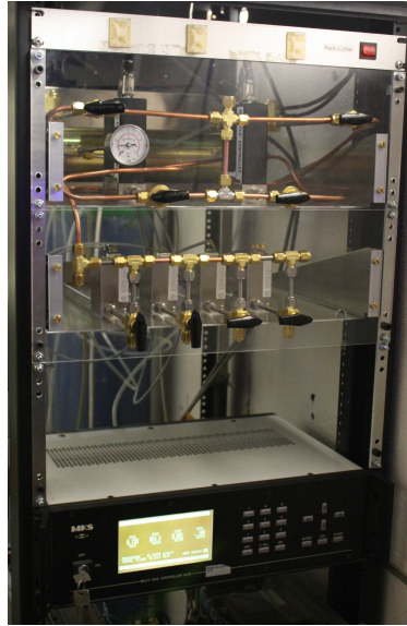
Abbildung 4.8.: Installation des Gassystems in der Experimentierhalle mit Mischebene (oben), einer Verteilerebene (darunter) und dem MKS 647b (unten)
