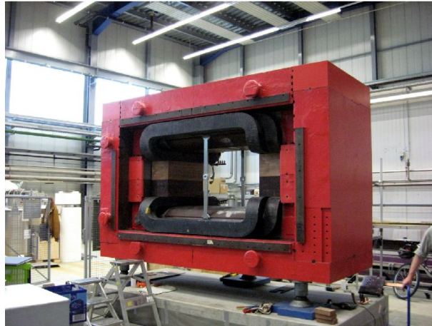
Abbildung 2.6.: Vermessung des offenen Dipolmagneten an der GSI in Darmstadt. [Els10c]
