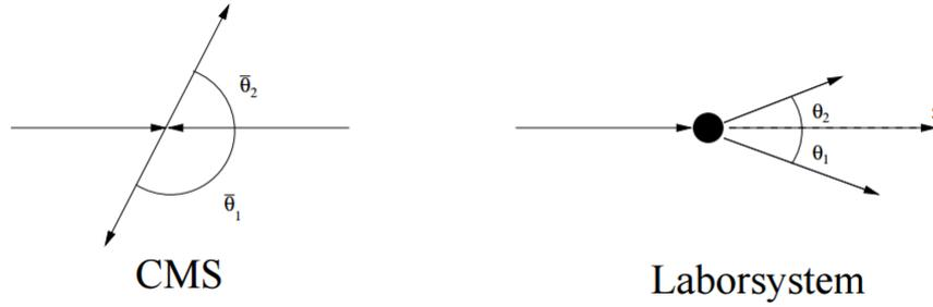
Abbildung 3.1: Beziehung zwischen Schwerpunktsystem (links) und Laborsystem (rechts)[EB06]
