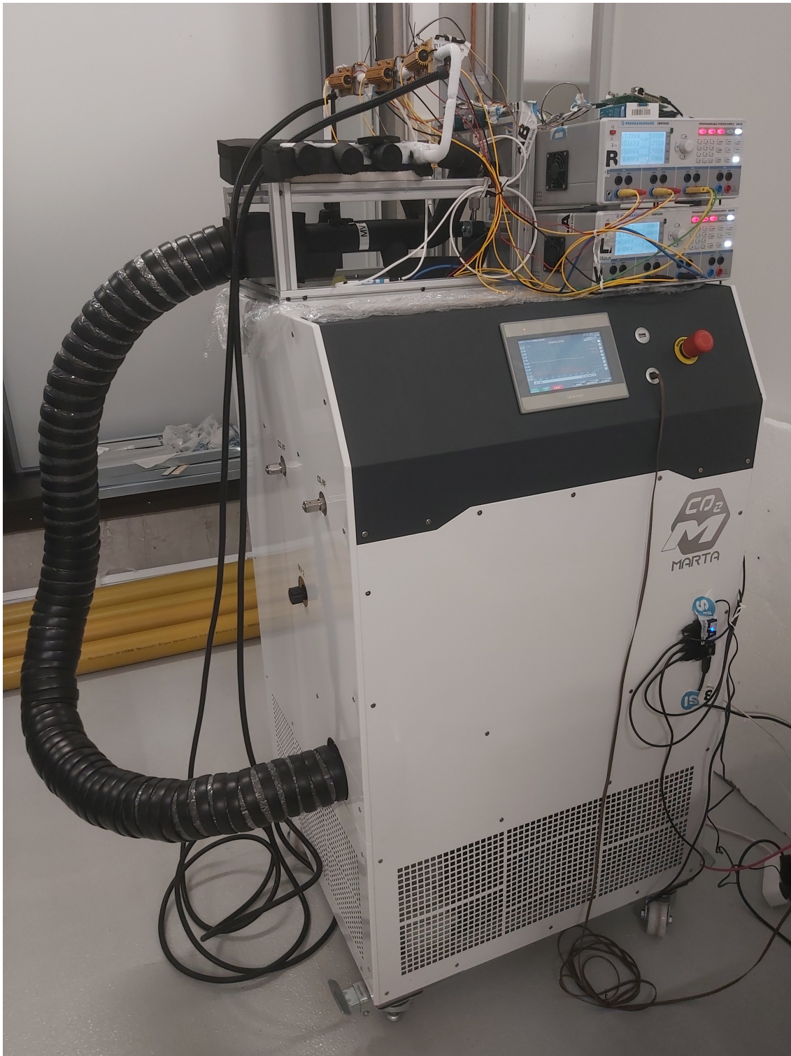
Abbildung 4.1: Der gesamte Versuchsaufbau. Rechts außerhalb des Bildes ist der Rechner zur Datenerfassung. Auf MARTA steht die Local Box mit den Lastwiderständen sowie die Netzteile. Die Mikrocontroller zur Datenerfassung der Temperatursensoren liegen auf den Netzteilen.
