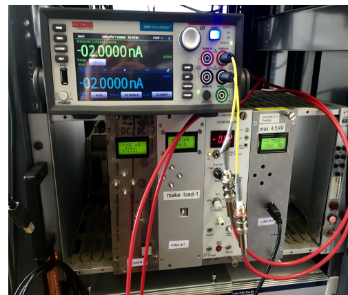
Abbildung 3.2: Kalibrationsaufbau: Gezeigt ist der Strommonitor mit USB-Anschluss und Präzisions- \mu\text{A} -Meter (SMU)
