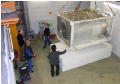
Installation des Magneten am DESY, Hamburg
