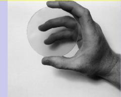
Idee: CVD Diamant Detektoren als Strahlprofilmonitor
