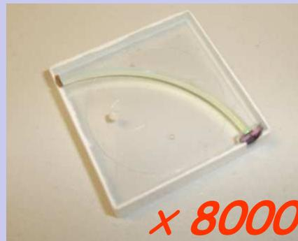
Szintillator-Ebene für Prototypen
